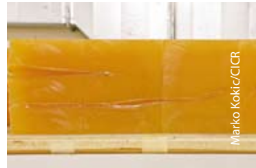
Trayectos de las balas de dos pistolas diferentes de 9 mm disparadas en un bloque de jabón
