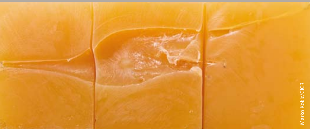
Trayecto de una bala de fusil encamisada de 7,62 mm disparada en un bloque de jabón
