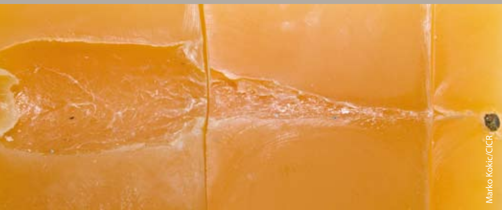
Trayecto de una bala de fusil semiencajada de 7,62 mm disparada en un bloque de jabón
